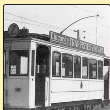
Elektriciteitstoevoer via trolley'stang ("perche")
